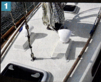
1 STADGA. Med höjd rigg gör det inre förstaget på rufftaket att masten står stadigt.
