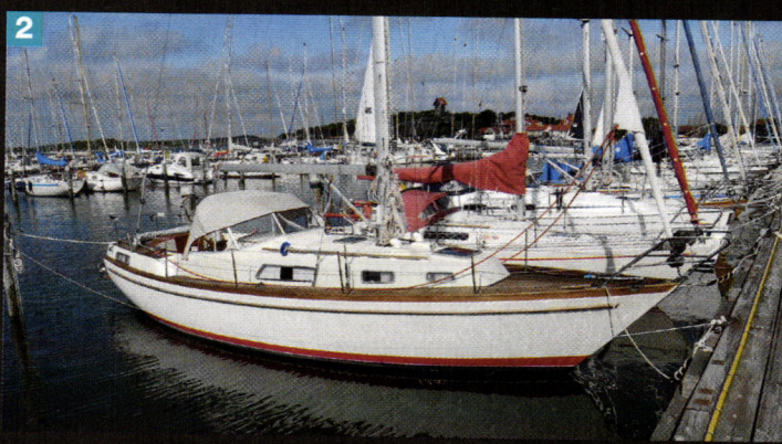
1 STADGA. Med höjd rigg gör det inre förstaget på rufftaket att masten står stadigt.
